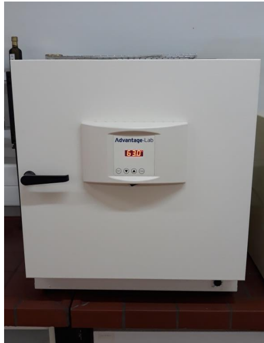
Slika 16 Sušionik za provedbu Oven testa na 63 °C
