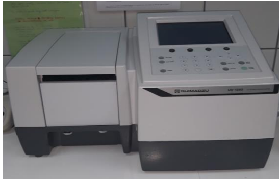
Slika 6 UV spektrofotometar (Shimadzu)
