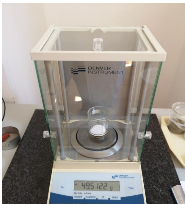
Slika 13 Odvaga filtera prije filtracije
