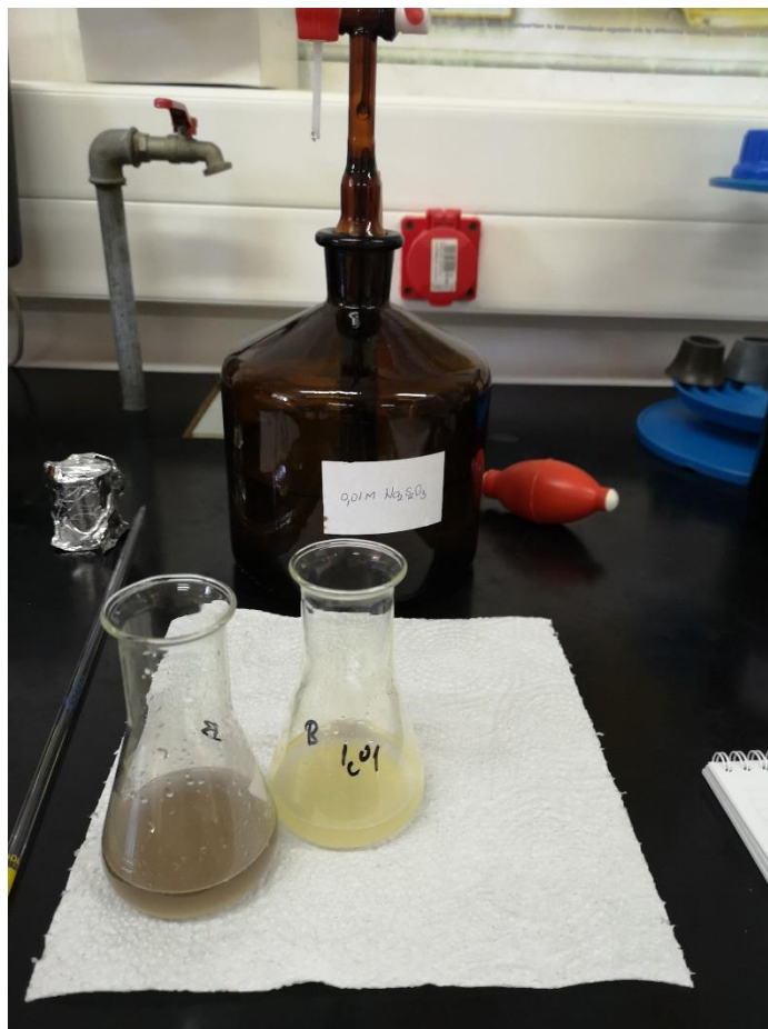
Slika 12 Određivanje peroksidnog broja
