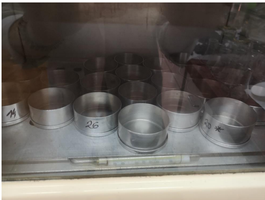
Slika 10 Sušenje praznih posudica za određivanje vode
