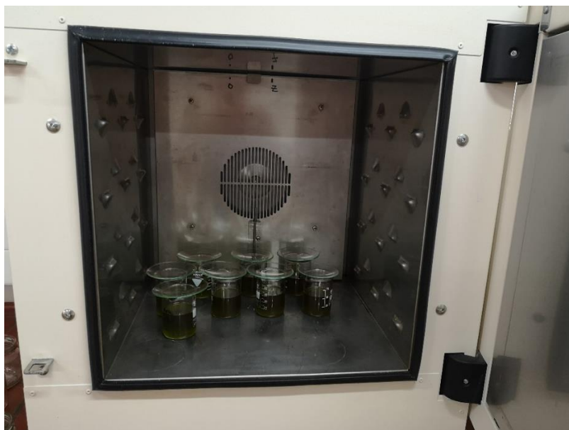
Slika 19 Uzorci u sušioniku (termostatu)
