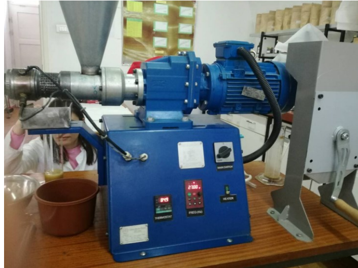
Slika 9 Kontinuirana pužna preša
