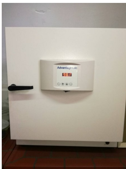
Slika 14 Sušionik zagrijan na 98 °C
