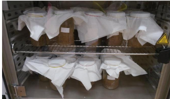
Slika 3.14. Uzgoj Trametes versicolor TV-6 na pljevici ječma u uvjetima fermentacije na čvrstim nosačima s ciljem proizvodnje lakaze ( T = 27 \text{ }^\circ\text{C} , t = 10 \text{ dana} )
