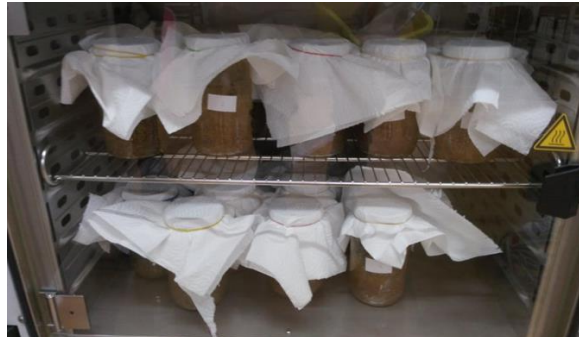
Slika 3.14. Uzgoj Trametes versicolor TV-6 na pljevici ječma u uvjetima fermentacije na čvrstim nosačima s ciljem proizvodnje lakaze ( T = 27\text{ }^{\circ}\text{C} , t = 10 dana)
