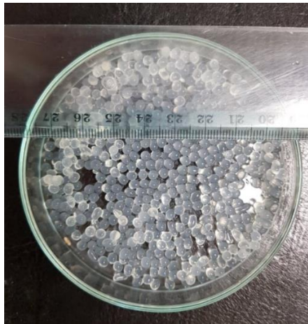
Slika 3.14. Kapsule alginata s imobiliziranim enzimom lakaza
