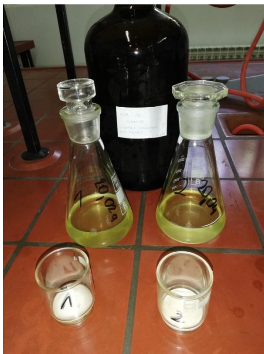
Slika 23 i Slika 24 Određivanje netopljivih nečistoća u ulju
