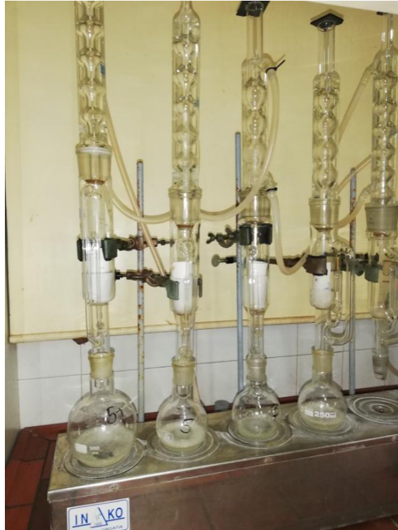
Slika 21 Aparatura za određivanje udjela ulja po Soxhlet-u
