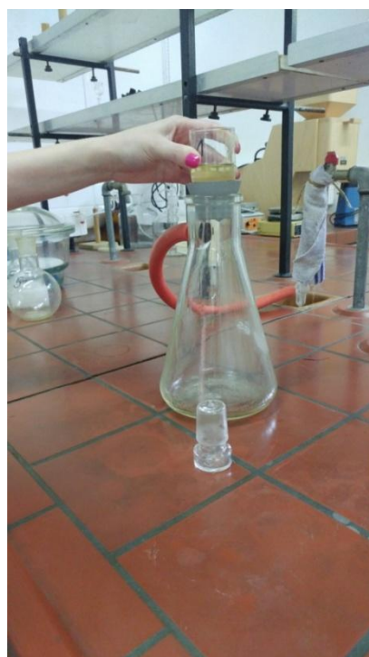
Slika 23 i Slika 24 Određivanje netopljivih nečistoća u ulju
