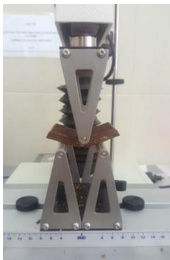
Slika 11 Mjerenje tvrdoće čokolade na analizatoru TA.XT Texture Analyser (Anić, 2019)
