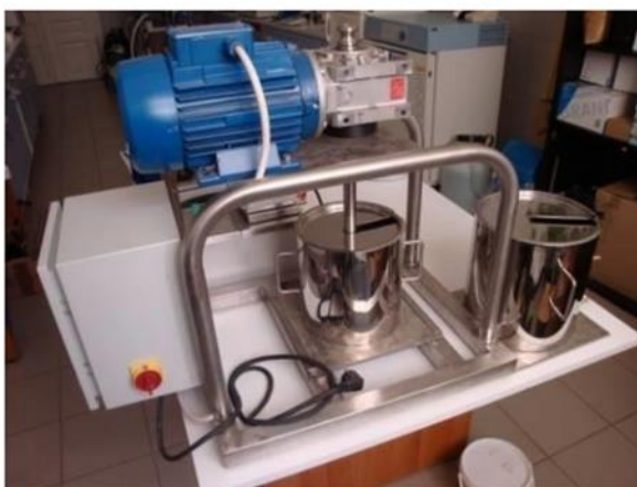
Slika 8 Prikaz kugličnog mlina (web izvor 5)
