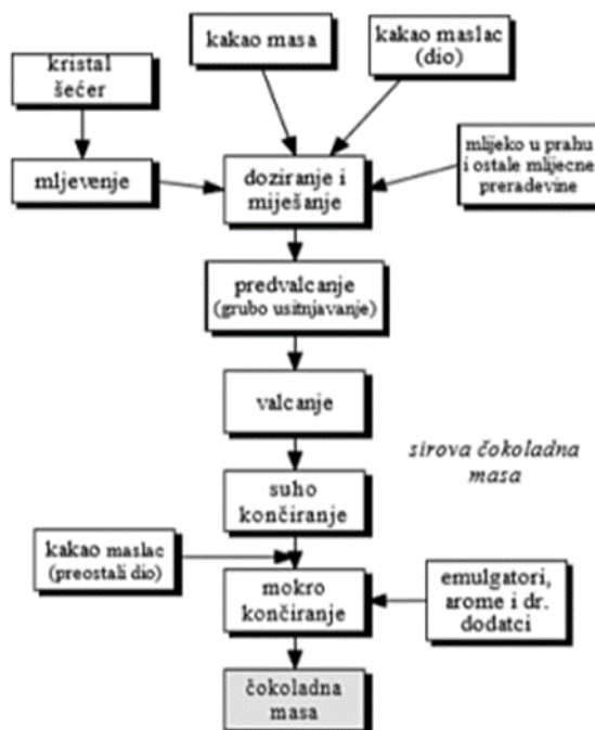
Slika 6 Shematski prikaz proizvodnje čokolade (Škrabal, 2009)
