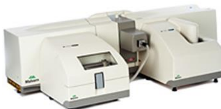
Slika 12 Određivanje veličine čestica pomoću Mastersizer 2000 (web izvor 7)
