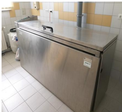
Slika 11 Uređaj za mikroslađenje Poljoprivrednog instituta Osijek (Havlik, 2019.)
