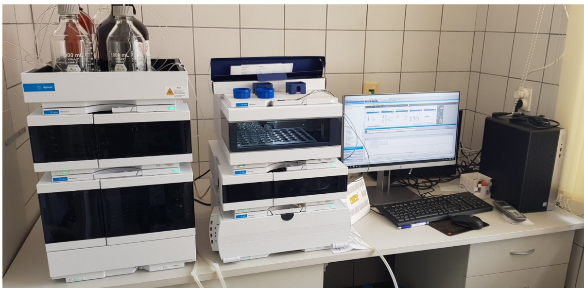
Slika 16 HPLC-DAD uređaj (Izvor: autor)
