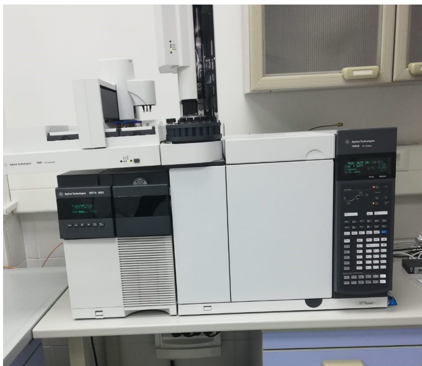
Slika 13 GC/MS uređaj (Izvor: autor)
