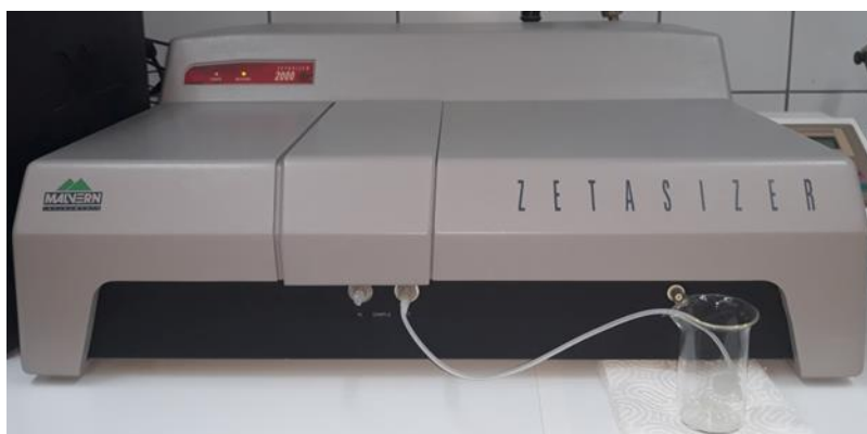
Slika 9 Instrument za mjerenje zeta potencijala Malvern Zetasizer 2000
