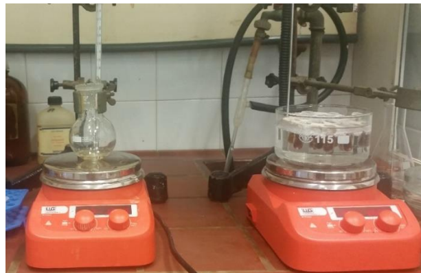
Slika 19 Priprema eutektičke smjese kolin-klorid-oksalna kiselina (lijevo), ekstrakcija bioaktivnih komponenata iz kakaove ljuske u različitim udjelima eutektičkog otapala i vode (desno)
