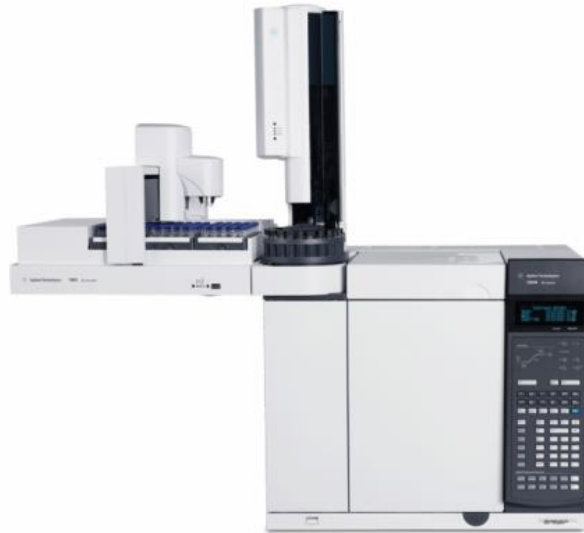
Slika 26 Plinski kromatograf s plameno ionizacijskim detektorom (7890B Agilent Technologies, Lake Forest, SAD)
