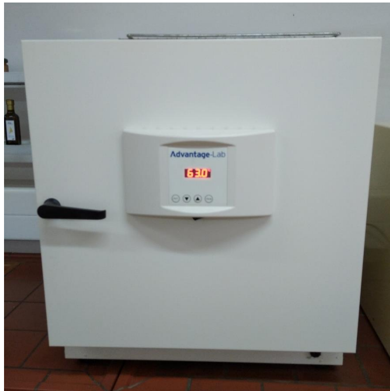
Slika 8 Sušionik za određivanje oksidacijske stabilnosti Schaal Oven testom na 63°C
