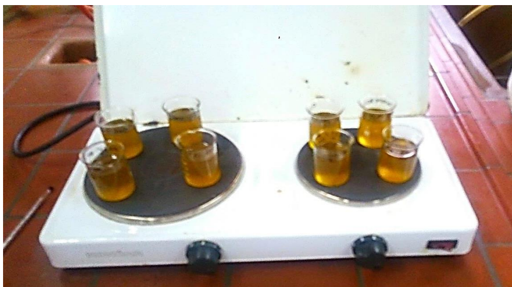
Slika 9 Priprema uzoraka ulja za provedbu testa
