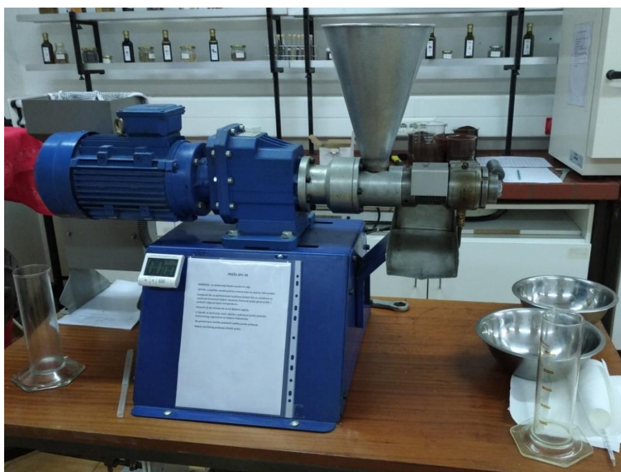
Slika 7 Laboratorijska pužna preša
