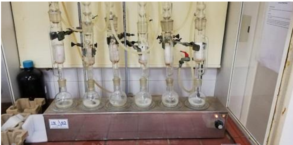
Slika 14 Aparatura za ekstrakciju ulja po Soxhlet-u
