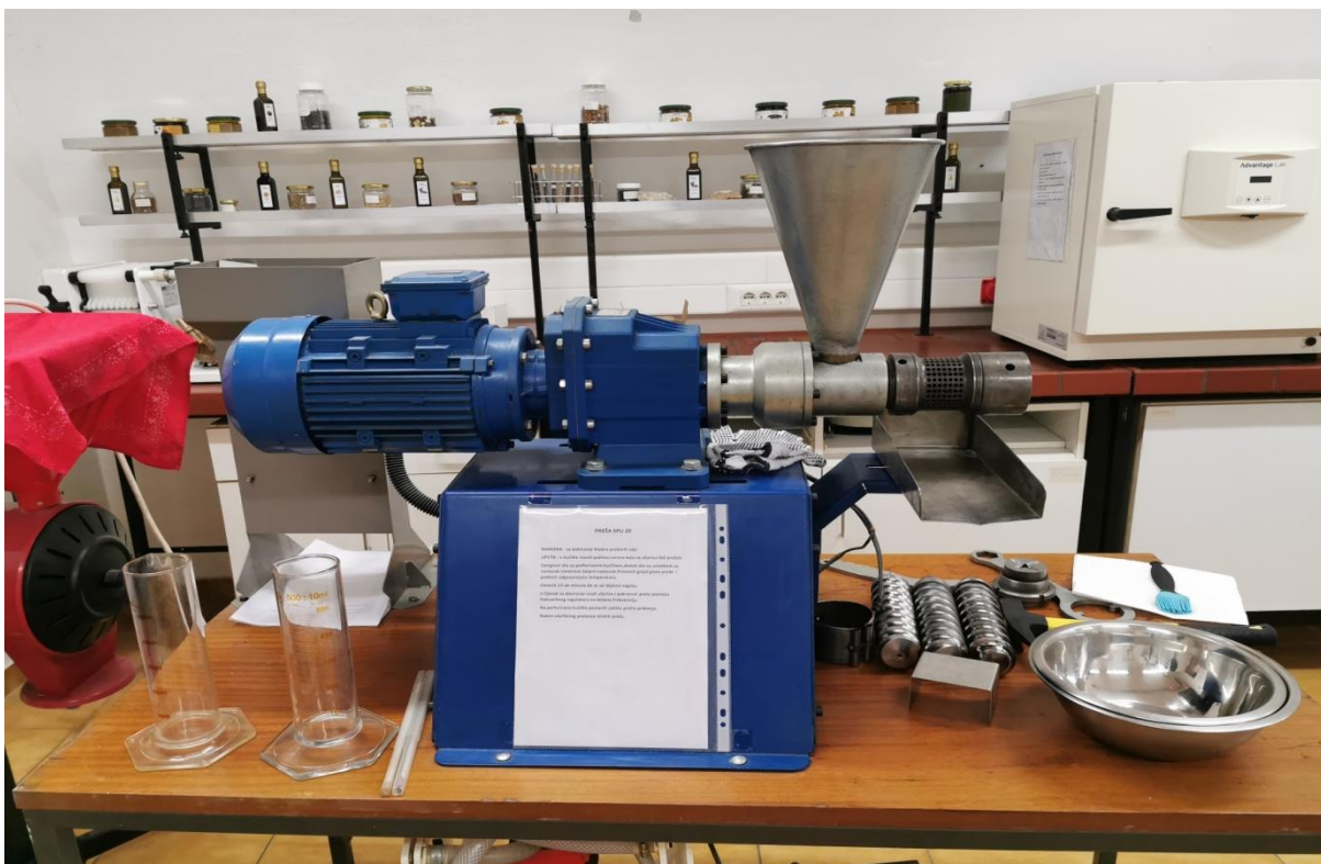
Slika 7 Laboratorijska kontinuirana pužna preša proizvođača ElektroMotor-Šimon d.o.o.
