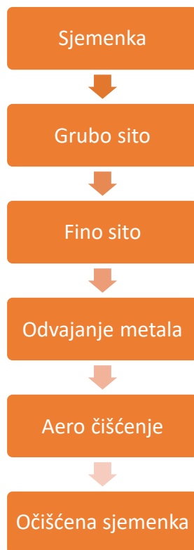
Slika 6 Shema čišćenja sjemenke (Bockisch, 1998.)
