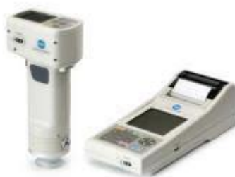
Slika 14 Kromametar Konica Micolta CR-400 (Barišić, 2018)
