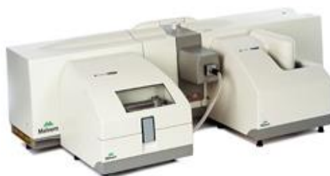
Slika 17 Mastersizer laser 2000 (web izvor 8)
