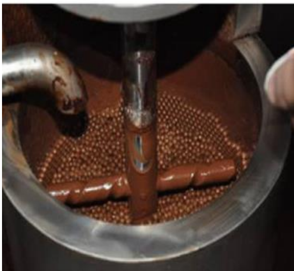
Slika 8 Unutrašnjost kugličnog mlina (Gutiérrez, 2017)
