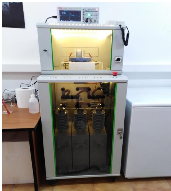
Slika 11 Uređaj za tretiranje hrane pulsirajućim električnim poljem
