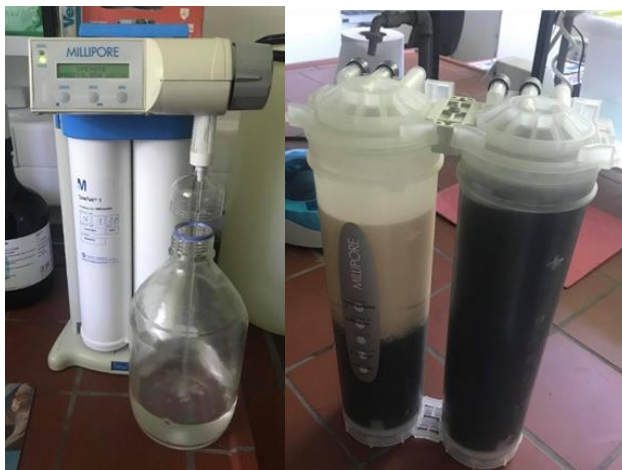
Slika 2 Uređaj za dobivanje vode visoke čistoće (lijevo) i filtri koji se nalaze u uređaju (desno)
