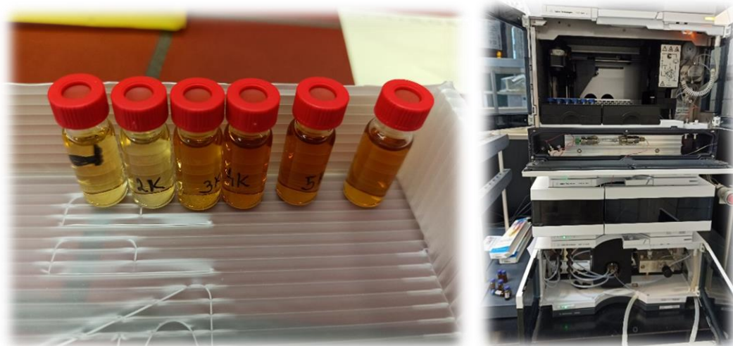
Slika 17: Prikaz uzorka i HPLC uređaja (Izvor: autor)
