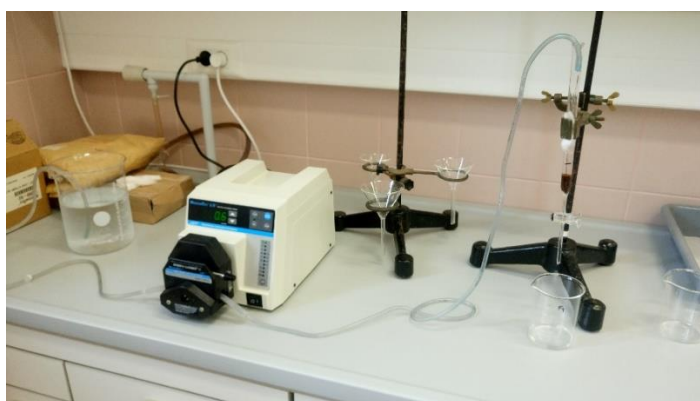
Slika 7 Prikaz sustava za ispitivanje adsorpcije u koloni
