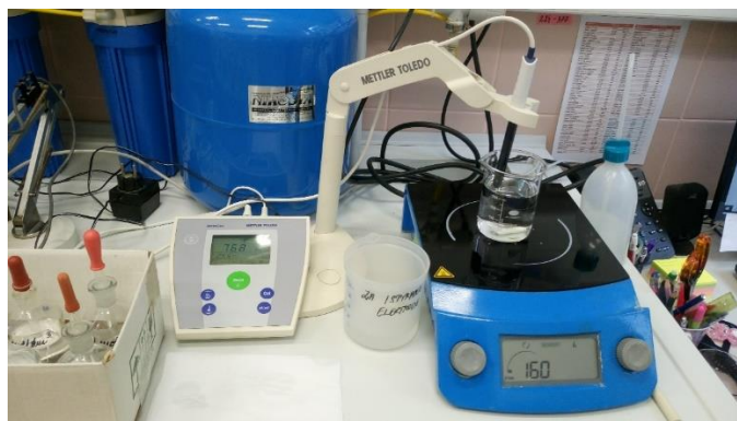
Slika 8 Laboratorijski pH metar Seven Easy, Mettler Toledo
