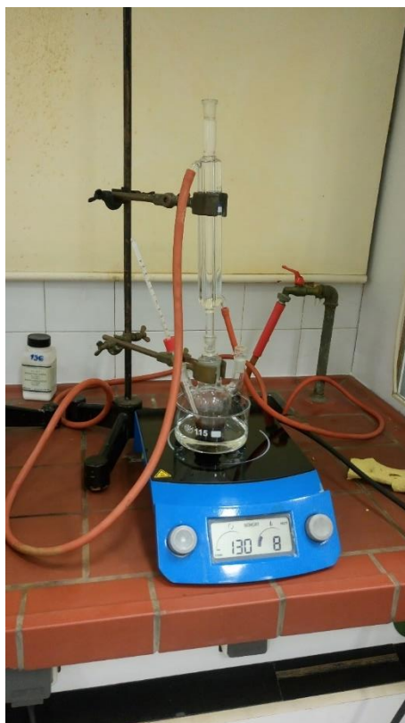
Slika 2 Aparatura za modifikaciju ljuske kakaovca
