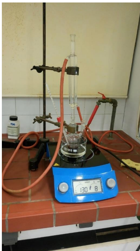
Slika 2 Aparatura za modifikaciju ljuske kakaovca
