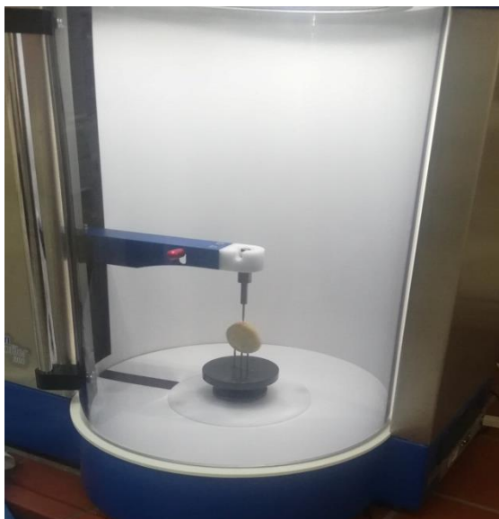
Slika 7. Uređaj za određivanje volumena Volscan Profiler
