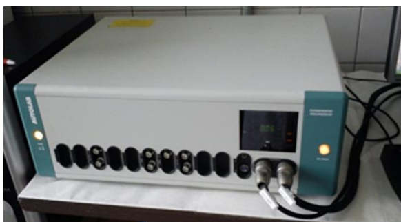
Slika 4. Potencijostat za mjerenje voltametrijskim tehnikama
