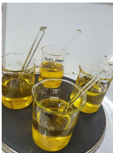
Slika 16 Zagrijavanje uzoraka ulja kukuruznih klica i antioksidansa pri temperaturi od 70 °C (Autor)
