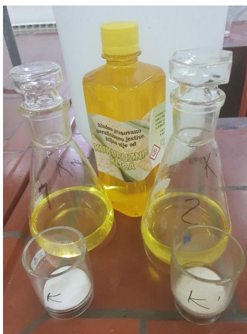
Slika 13 Određivanje udjela netopljivih nečistoća u ulju kukuruznih klica (Autor)
