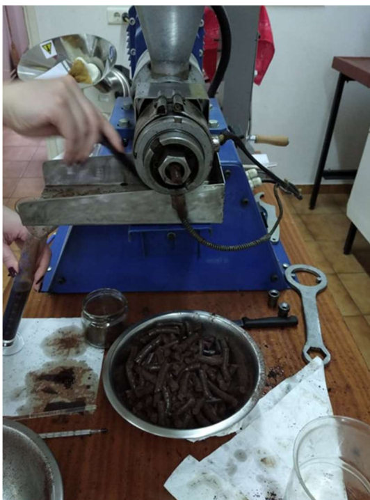
Slika 17 Izlazak pogače tijekom prešanja
