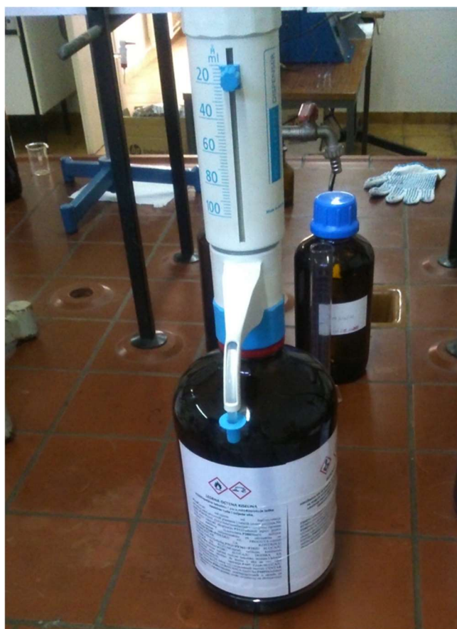
Slika 22 Automatski dispencer s ledenom octenom kiselinom
