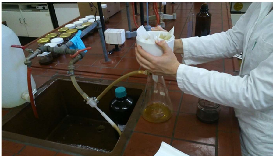
Slika 18 Vakuum filtracija sirovog ulja sjemenki noćurka
