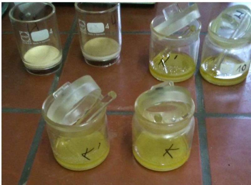
Slika 23 Staklene čašice za određivanje vlage u ulju
