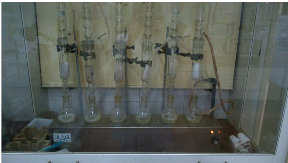
Slika 21 Aparatura po Soxhletu za određivanje udjela ulja
