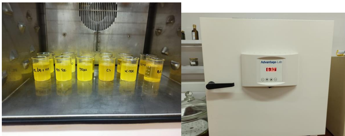
Slika 12 Priprema uzoraka pileće masti za Schaal Oven test i sušionik za provedbu testa na 63 °C
