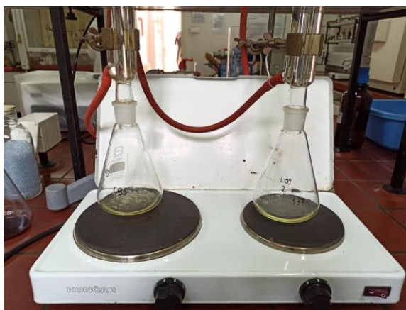
Slika 11 Određivanje broja osapunjenja
