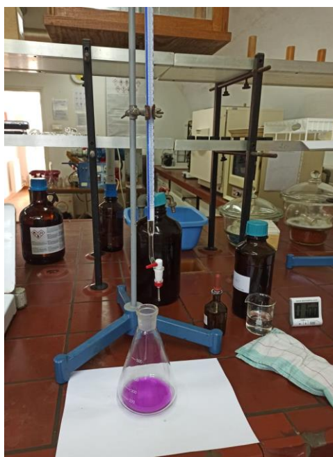
Slika 10 Određivanje slobodnih masnih kiselina
