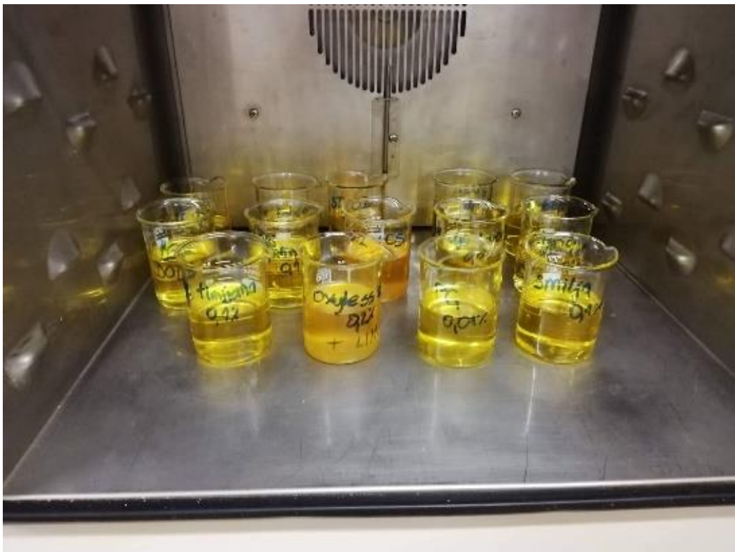
Slika 25 Pripremljeni uzorci u sušioniku za početak Oven testa
