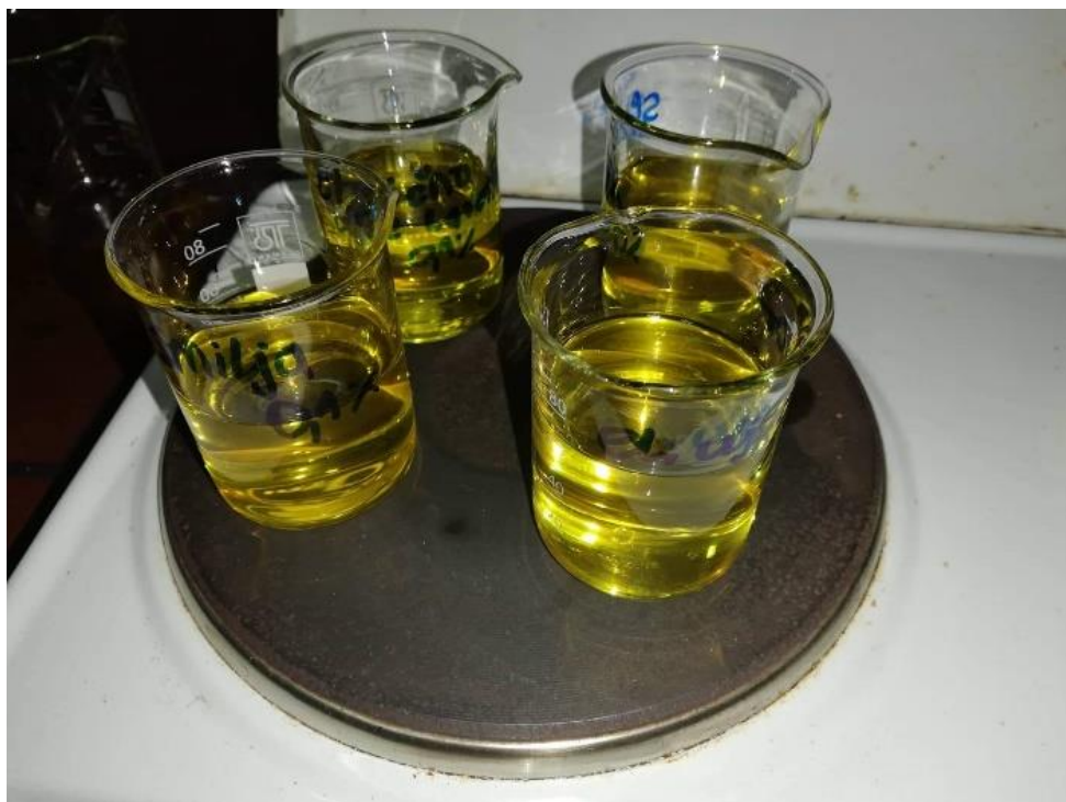
Slika 24 Zagrijavanje uzoraka ulja s dodanim antioksidansima
