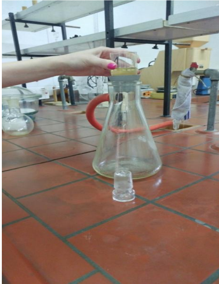
Slika 22 Primjena vakuum filtracije
