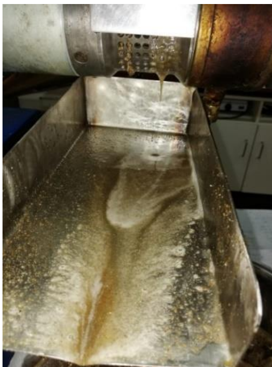
Slika 11 Proces proizvodnje hladno prešanog ulja sikavice primjenom pužne preše
