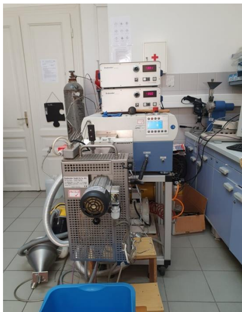
Slika 8 Jednopužni laboratorijski ekstruder 19/20 DN, Brabender GmbH, Duisburg, Njemačka
