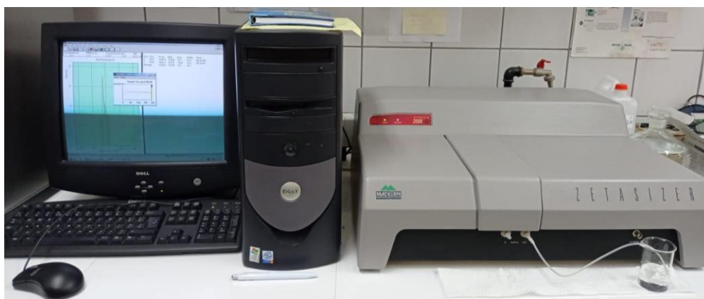
Slika 6 Uređaja za mjerenje zeta potencijala (Zetasizer 2000)
