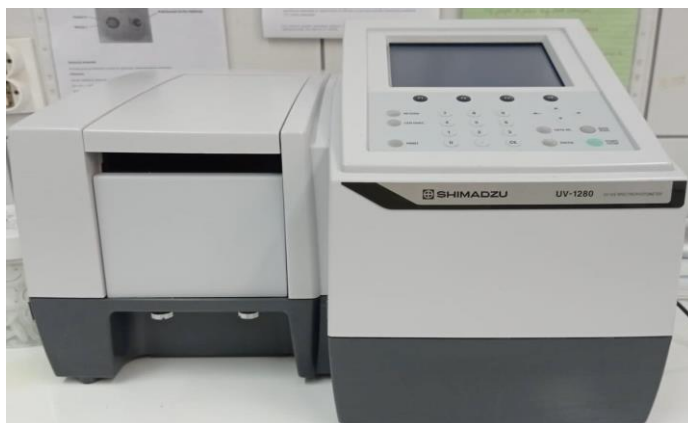
Slika 5 Prikaz UV/Vis spektrofotometra (Shimadzu UV-1280)
