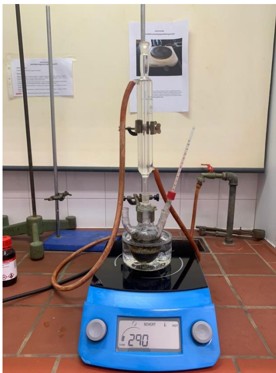
Slika 6: Aparatura korištena za kemijsku modifikaciju ljuske suncokreta
