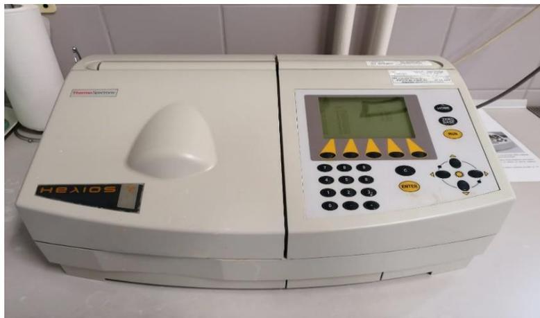
**Slika 14** Spektrofotometar (Spectronic Helios Gamma UV-Vis spektrofotometar; Thermo Fisher Scientific) (Izvor: autor)
