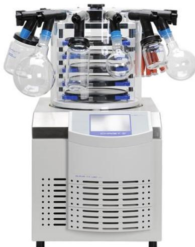
**Slika 9** Liofilizator (Christ, Alpha LSCplus, Njemačka)
