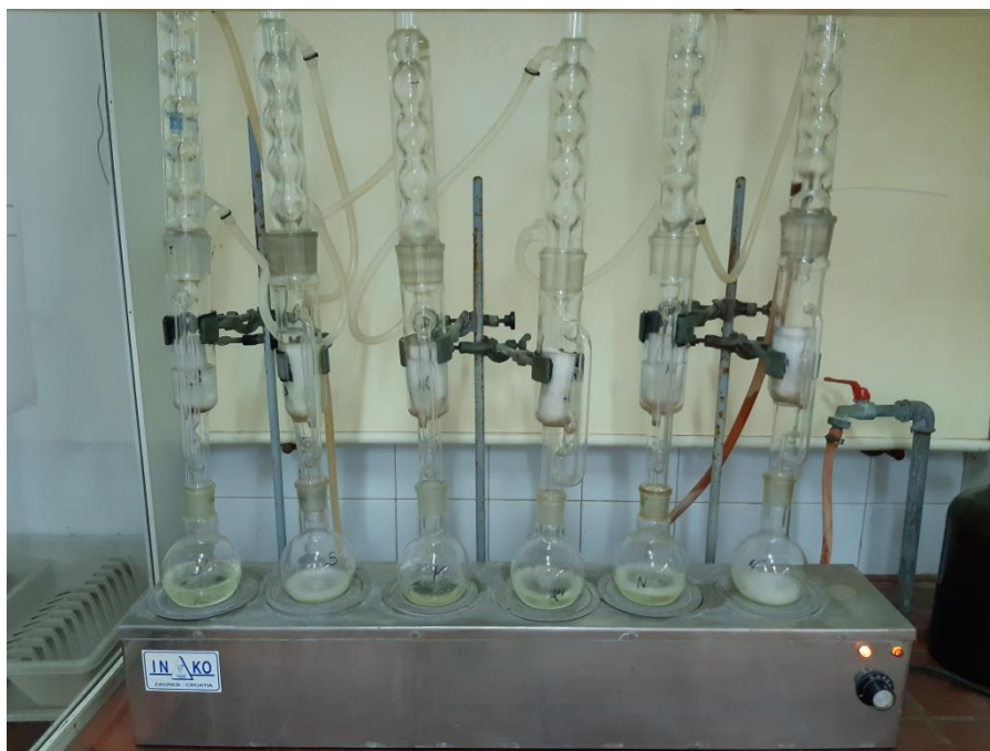
Slika 14 Metoda ekstrakcije po Soxhlet-u
