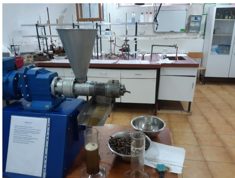
Slika 6 Prešanje sjemenki indijskog lana
