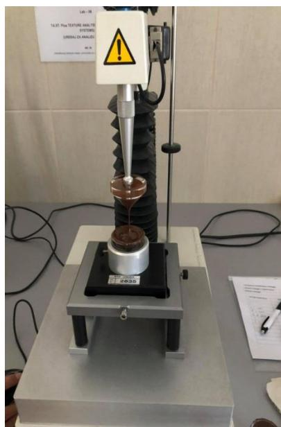
**Slika 12** Prikaz uređaja za određivanje tekture
