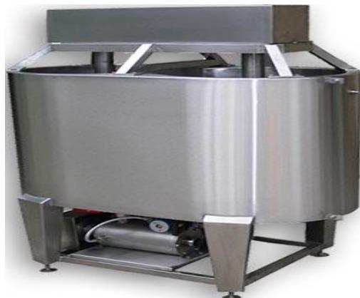
**Slika 6** Kuglični mlin (Web 6)
