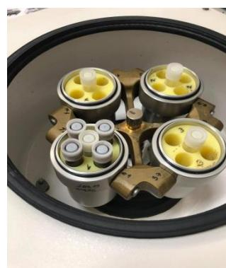
**Slika 11** Unutrašnjost uređaja Centra – MP4R
