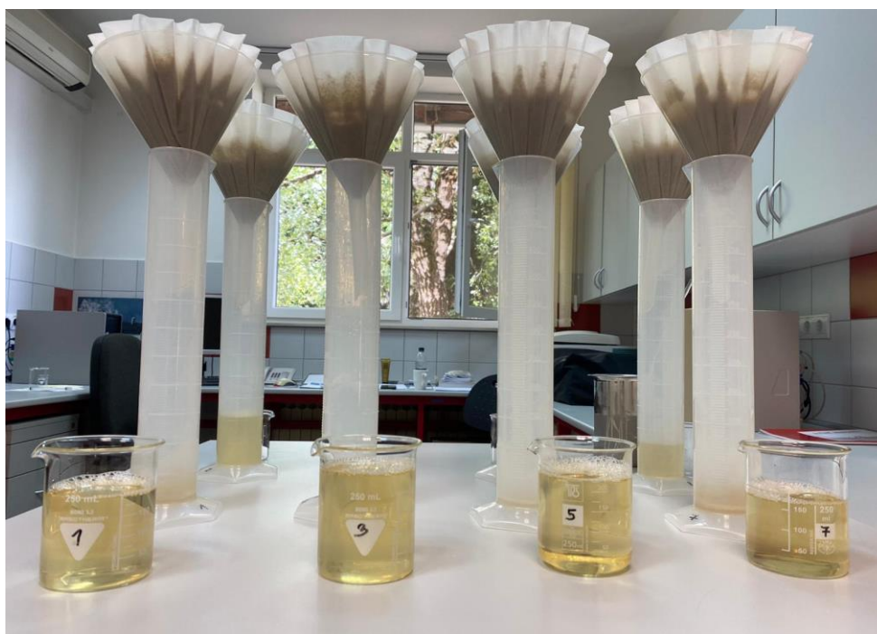
Slika 18 Prikaz filtracije sladovine (Poljoprivredni Institut Osijek, 2020)
