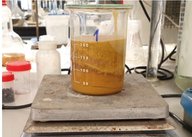
Slika 10 Zakiseljeno otpadno ulje na magnetnoj miješalici
