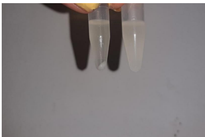
Slika 8 Razlika centrifugiranog i necentrifugiranog uzorka
