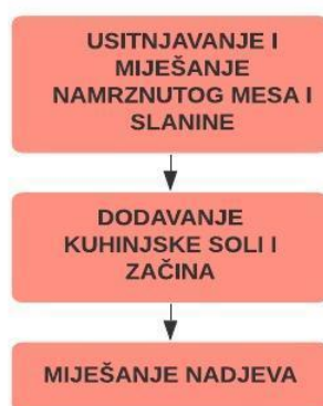
Slika 5 Shematski prikaz tehnologije miješanja, usitnjavanja i začinjavanja mesa (Kovačević, 2015)
