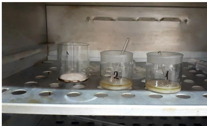
Slika 29 Sušenje uzorka ulja u sušioniku 2 sata
