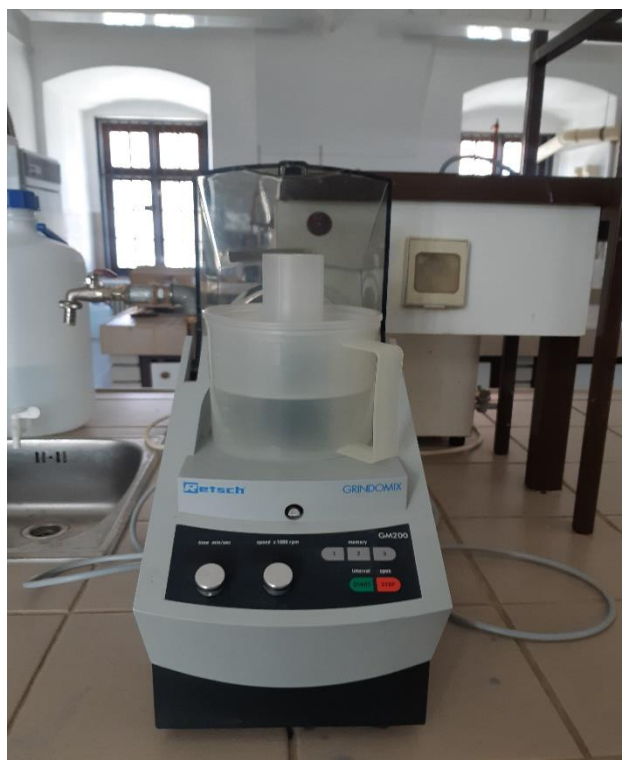
Slika 13 Uređaj za usitnjavanje materijala
