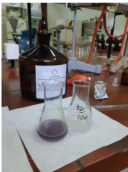
Slika 15 Određivanje Pbr (lijevo-uzorak prije titracije; desno-uzorak nakon titracije)
