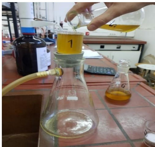
Slika 21 Proces filtracije uz pomoć vakuuma
