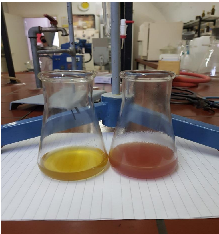
Slika 19 Određivanje slobodnih masnih kiselina u ulju
