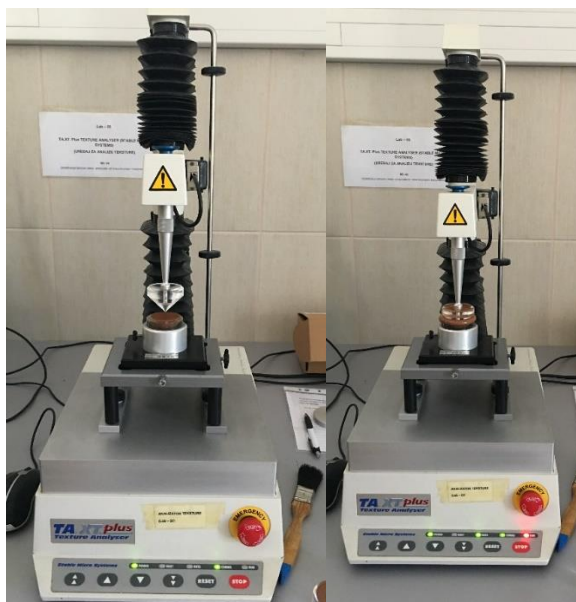
Slika 25 Prikaz prodiranja nastavka konusnog oblika za određivanje teksture
