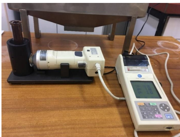
Slika 22 Kromametar CR-400, Konica Minolta
