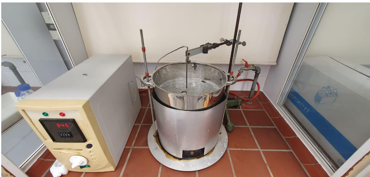
Slika 2 Aparatura za uparavanje kalcijeva klorida
