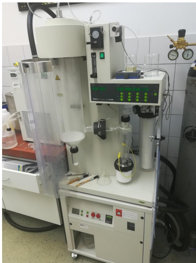
Slika 3 Uređaj za sušenje raspršivanjem Mini Spray Dryer B-290
