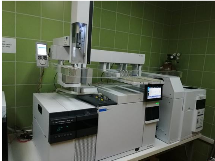
Slika 10 Mikroekstrakcija vršnih para na krutoj fazi (automatski sustav) zajedno s vezanim sustavom plinska kromatografija i spektrometrija masa (Izvor: autor)
