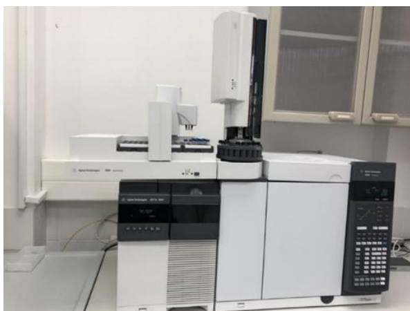
Slika 14 Vezani sustav plinska kromatografija i spektrometrija masa (GC-MS) (Izvor: autor)
