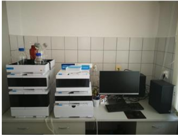
Slika 16 HPLC sustav korišten za identifikaciju i kvantifikaciju pigmenata u ekstraktima makroalgi (Izvor: autor)
