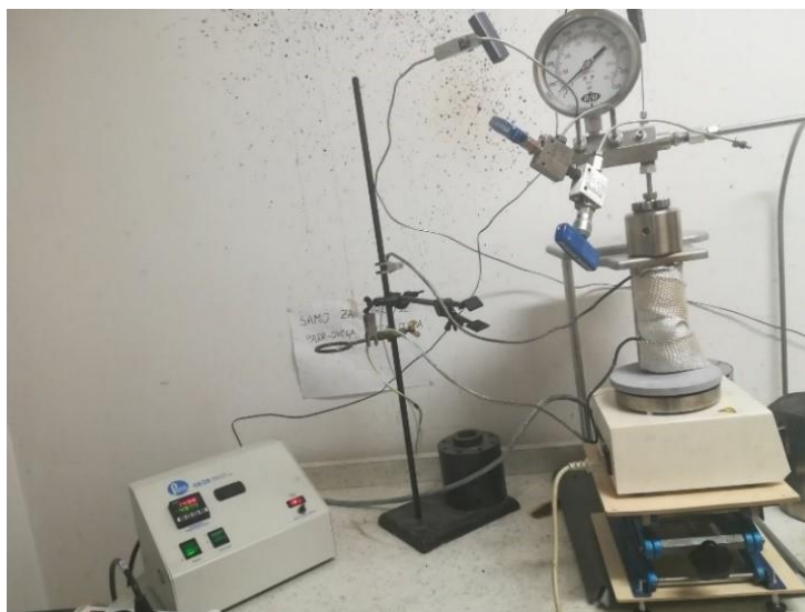
Slika 8 Uređaj za ekstrakciju s vodom u supkričnom stanju (Parr Instrument Company, USA) (Izvor: autor)
